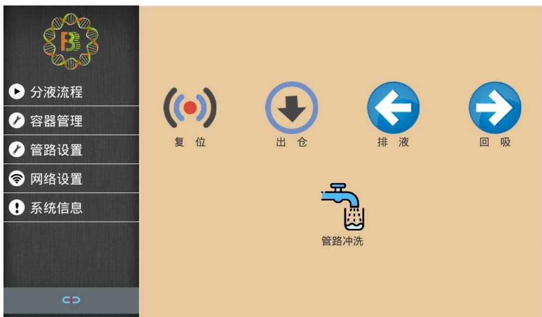
快捷桌面区包含复位、出仓/入仓、排液、回吸和管路冲洗 5 个快捷功能键，“复位”按钮可以对平台进行水平轴向的复位，此时加液头在废液槽上方；“出仓/入仓”按钮可以控制载物台出入平台方便更换容器；“排液”按钮可以通过排液对赶出管路中的气泡；“回吸”按钮可以将管路中残留的试剂进行回吸；“管路冲洗”按钮可以对分液前的管路进行清洗，保证分液管路的清洁。
