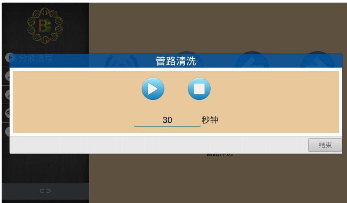
可以设定管路冲洗时间，设定好后点击开始按钮，弹出注意窗口，提示该功能需将针管从平台移动滑块上取下，将加液针头手动对准较大容器，防止清洗液体过多溢出到仪器内部。
