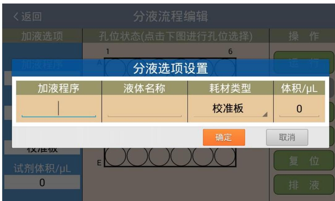
在此界面可定义加液程序的名称、液体的名称种类，选择耗材类型（容器的型号），分液的体积，填写完毕后点<确定>返回分液流程编辑界面。
