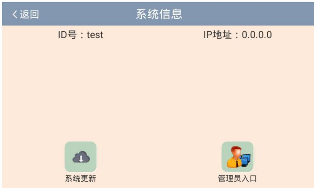
系统信息显示平台的 ID 号及 IP 地址，并具有系统更新功能及管理员入口。系统更新可以显示当前软件的版本号并可通过网络进行软件升级；管理员入口可对平台的电机驱动参数进行维护，只有产品维修人员才能进入操作，使用人员严禁修改。
