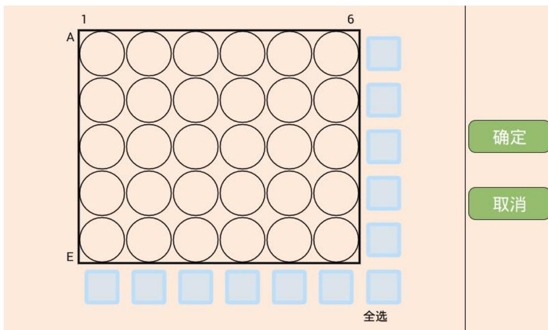
在此界面可以通过点击选择需要分液的孔位，可以通过点击右下角选择框进行全选，也可以分别点击右侧和下侧的选择框进行整行或整列的选择，还可以根据自己的需要直接在容器中单个点选孔位。选择完毕点击<确定>返回到分液流程编辑界面。
