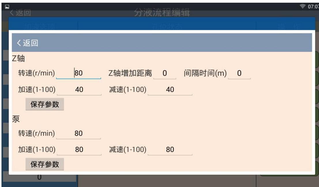
设置 Z 轴电机和泵电机的转速和加减速等参数，使液滴更顺利地滴下；Z 轴增加距离参数和间隔时间参数相配合，可使加液过程中 Z 轴加液高度随液氮液面下降而下降，保证针头始终贴近液氮液面加液，提高加液液滴的完整性和成球性，**当所要制作的冻珠体积较大，难以在针头上完整悬挂或滴落时难以保持完整时，建议设置使针头贴近液氮面加液；**设置完成后分别点击<保存参数>按钮，保存完成后点击<返回>按钮返回到分液流程编辑液面。
