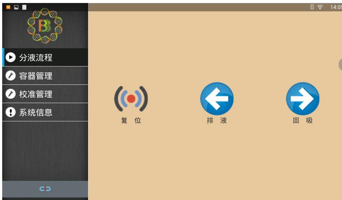
快捷桌面区包含复位、排液、回吸 3 个快捷功能键，<复位>按钮可以对仪器的所有运动构件进行复位，将针头架置于默认位置；<排液>按钮可以通过排液赶出管路中的气泡；<回吸>按钮可以将管路中残留的试剂进行回吸。
